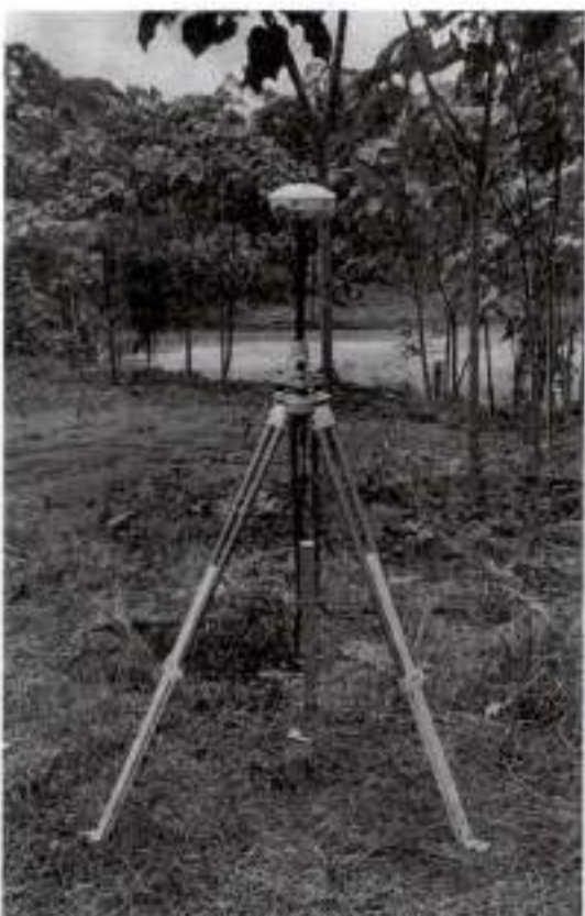
Colocación de Punto GNSS para georreferenciación.
