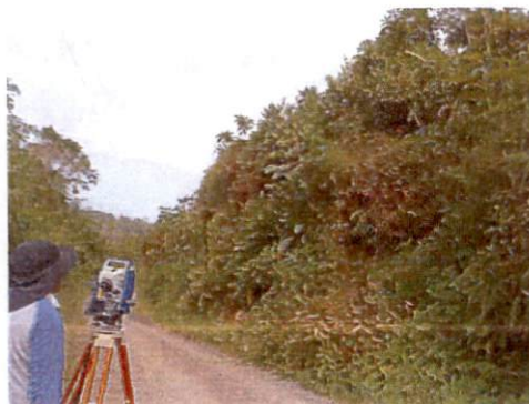
Fotografía 3: Levantamiento topográfico de taludes
