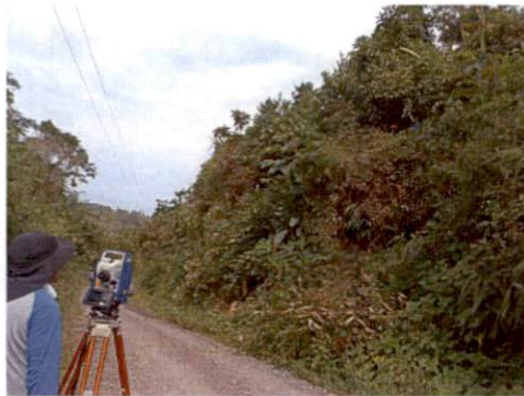
Fotografía 3: Levantamiento topográfico de taludes
